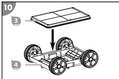
2. Montare la parte superiore **2** sulla parte inferiore **4** in modo che si incastrino correttamente in entrambi i lati.
