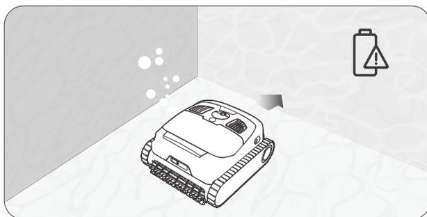
Se o dispositivo permanecer na linha de água durante mais de 5 minutos sem ser retirado, o mesmo regressará ao chão da piscina e permanecerá junto à parede. Os utilizadores podem ligar o gancho a qualquer vara telescópica de piscina padrão (não incluída) para aumentar o alcance do gancho e retirar o dispositivo do chão da piscina.
