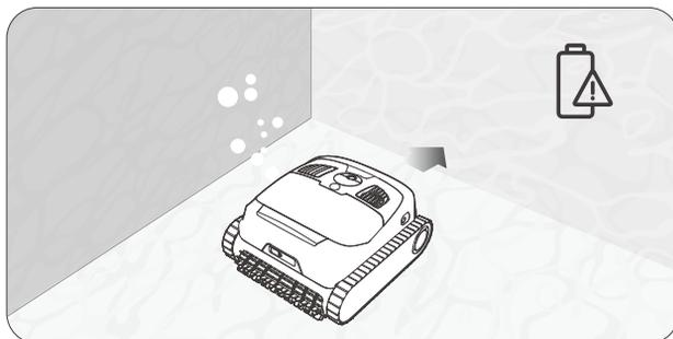
Si l'appareil reste à la ligne d'eau pendant plus de 5 minutes sans être récupéré, il reviendra au fond de la piscine et se positionnera près de la paroi. Les utilisateurs peuvent fixer le crochet à n'importe quelle manche télescopique de piscine standard (non inclus) afin d'augmenter sa portée, puis accrocher et retirer l'appareil du fond de la piscine.
