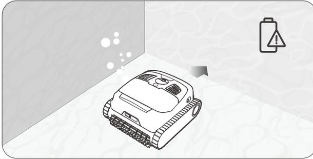
Bleibt das Gerät länger als 5 Minuten an der Wasserlinie, ohne herausgeholt zu werden, kehrt es auf den Poolboden zurück und bleibt in der Nähe der Wand. Der Benutzer kann den Haken an jeder handelsüblichen teleskopischen Poolstange (nicht im Lieferumfang enthalten) befestigen, ausfahren und einhaken, um das Gerät vom Poolboden hochzuziehen.
