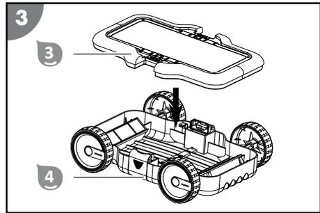
2. Setzen Sie das Oberteil **2** in das Unterteil **4** ein, bis dieses beidseitig eingerastet ist. Die Filtereinheit ist eingesetzt.
