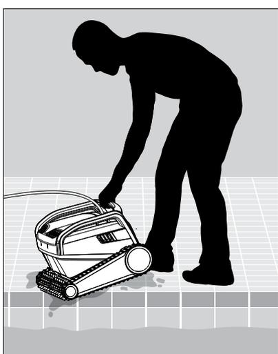
**5.4.3** Placez le robot nettoyeur sur le bord de la piscine et laissez l'eau s'écouler.
