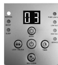
**BEACHTEN SIE:** Falls Sie vergessen die Tastensperre zu aktivieren, wird dies durch das Gerät automatisch vorgenommen und 1 Minute später beginnt das Salzwassersystem wieder zu arbeiten.
