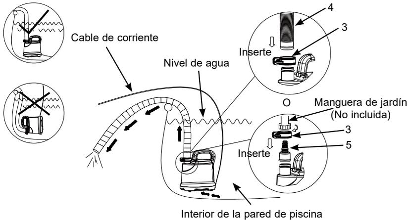
**NOTA:** La profundidad del agua máxima de la piscina no debe superar 48 pulgadas (1,22 m). Para evitar que el motor de la bomba pueda funcionar en vacío, desconecte el cable de la toma de corriente una vez que haya vaciado el agua o cuando el nivel de agua restante esté por debajo de la base de la bomba de desagüe.
