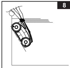
2. Afferrare l'impugnatura del pulitore con entrambe le mani, immergere il pulitore nell'acqua e scuoterlo avanti e indietro 3-5 volte per espellere tutta l'aria. Vedi fig. 8.
