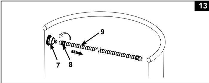
3. Desenrosque (no sentido inverso ao dos ponteiros do relógio) o adaptador da mangueira (7) do conector do coador rosado. Retire a micro-rede (6) do adaptador da mangueira. Use uma mangueira de jardim para limpar e eliminar quaisquer resíduos da micro-rede e do adaptador da mangueira. Veja Fig. 14.
