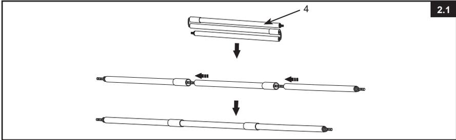
9) Faites glisser les tiges "B" dans les manchons courts de l'avant et assurez-vous que l'extrémité de la tige "B" est insérée dans le joint de tige en fibre de verre correspondant (1).
