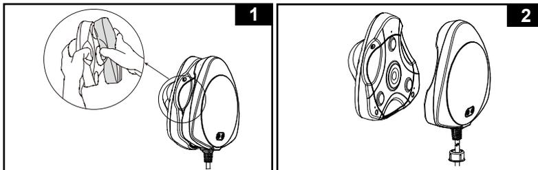
2. Coloque o transmissor (2) na parte de fora da parede da piscina e o iluminador da piscina submerso na água (1) na parte de dentro da parede da piscina. Assegurar que o pólo magnético do transmissor esteja devidamente alinhado com o pólo magnético na unidade do iluminador da piscina. **Veja ilustração (3).**
