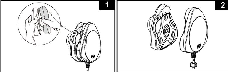
2. Coloque el transmisor (2) en la parte exterior de la pared de la piscina y coloque la luz (1) en la parte interna de la pared de la piscina sumergida bajo el agua. Verifique que los polos magnéticos del transmisor coincidan correctamente con los polos magnéticos del artefacto de luz. **Vea el dibujo (3).**
