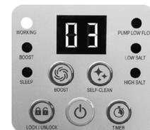
**Hinweis:** Falls Sie vergessen die Tastensperre zu aktivieren, wird dies durch das Gerät automatisch vorgenommen und 10 Sekunden später beginnt das Salzwassersystem wieder zu arbeiten.
