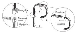
Desenrosque la rosca (6), Inserte el soporte y el mango apriete con el tornillo.
