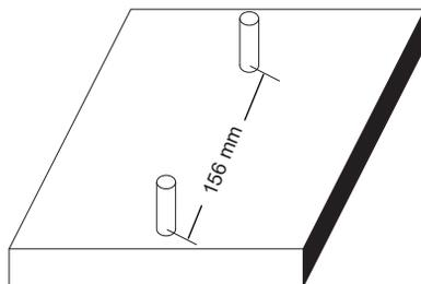
1. Os furos para montagem são de 6.4mm de diâmetro e 156mm de espaçamento.
