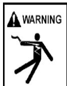
**⚠ AVVERTENZA - Rischio di folgorazione.** Collegare unicamente su una presa munita di terra, protetta da un interruttore automatico salvavita. Se non si è in grado di verificare se l'impianto elettrico è munito di tale dispositivo, mettersi in contatto con un elettricista qualificato.
