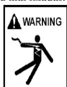
**! ADVERTÊNCIA – Risco de choque eléctrico.** Ligar unicamente a um receptáculo de ligação à terra através de um interruptor de circuito por falha de terra (GFCI). Se não lhe for possível verificar se o receptáculo está efectivamente protegido por um GFCI, consulte um técnico em electricidade competente.
