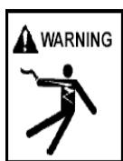
**⚠ AVERTISSEMENT – Pour limiter au maximum le risque de décharge électrique, remplacer immédiatement tout cordon endommagé. Ne pas enfouir le cordon dans le sol. Signaler l'emplacement du cordon pour réduire au minimum tout risque de dommage par les tondeuses à gazon, les taille-haies ou tout autre appareil.**
