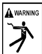
**⚠ WAARSCHUWING – Gevaar voor elektrische schokken.** Sluit alleen aan op een contactdoos met aarding en verliesstroomautomaat. Contacteren een bevoegd elektricien indien u zelf niet kunt controleren of de contactdoos met een verliesstroomautomaat is beveiligd.
