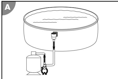
Filhační čerpadlo čerpá vodu ke koupání z bazénu do filtračního zařízení.
