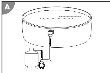
Pompa de filtrare pompează apă din piscină în instalația de filtrare.
