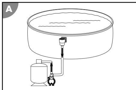
Die Filterpumpe pumpt das Badewasser vom Pool zur Filteranlage.
