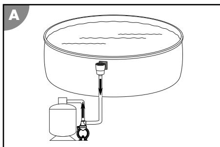
Pompa filtrująca pompuje wodę z basenu do urządzenia filtrującego.
