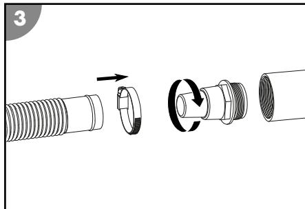
**INTEX yüzme havuzu hortumunu (teslimat kapsamına dahil değil) pompaya ya da filtre kabına vidalamak için uygulanacak adımlar:**
