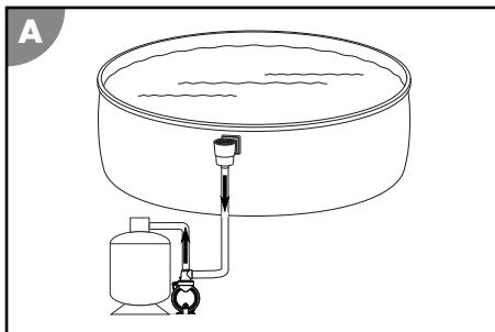
Filtre pompa banyo suyunu havuzdan filtr sistemine pompaliyor.
