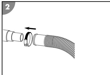
**Postupite na sljedeći način kako biste utaknuli crijevo za bazen na adapter crijeva pumpe ili kućišta filtra:**
