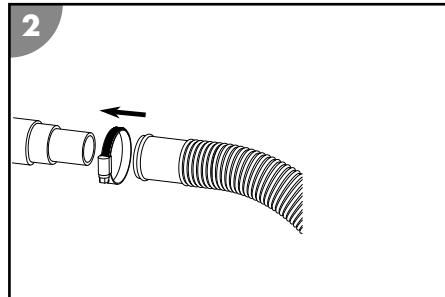
**Při nasazení bazénové hadice s pomocí adaptérů na hadici čerpadla nebo filtrační nádoby postupujte následovně:**
