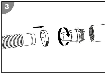
**Процедирайте, както следва, за да завинтите маркуч за плувен басейн INTEX (не е включен в обхвата на доставката) към помпата или помпата към филтърния корпус:**
