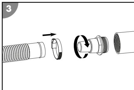
**Per avvitare un tubo flessibile per piscina INTEX (non in dotazione) alla pompa o al tamburo del filtro, procedere come segue:**
