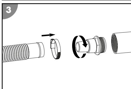
**Aby zamontować przewód basenowy INTEX (brak w zakresie dostawy) na pompie lub zbiorniku filtra metodą skręcania, postępuj zgodnie z poniższym opisem:**
