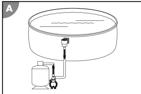
Filiačné čerpadlo čerpá vodu z bazéna do filtračného zariadenia.
