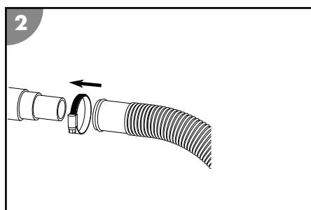
**Na nasunutie bazénovej hadice na hadicový adaptér čerpadla alebo filtračného kotla postupujte nasledovne:**
