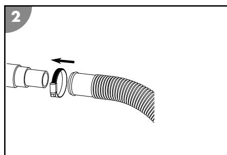
**Yüzme havuzu hortumunu pompanın ya da filtre kabının hortum adaptörüne takmak için şu adımları uygulayın:**
