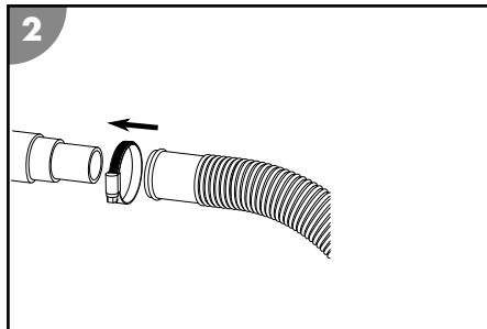
**Per inserire un tubo flessibile per piscina nell'adattatore tubo della pompa o del tamburo del filtro, procedere come segue:**
