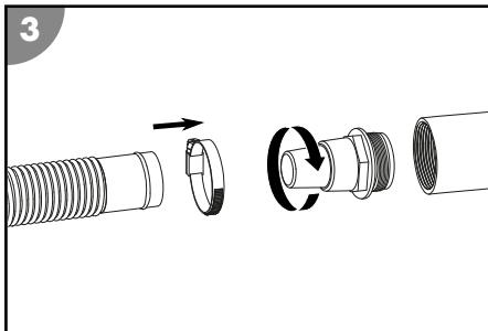
**Postupite na sljedeći način kako biste crijevo za bazen INTEX (nije sadržano u opsegu isporuke) vijcima pričvrstili na pumpu ili kućište filtra:**
