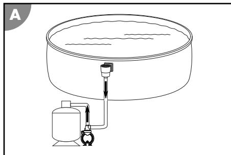
La bomba de filtración bombea el agua del baño de la piscina a la instalación de filtrado. Un filtro previo integrado impide la penetración de las partículas de suciedad más gruesas. Esto protege la bomba de los daños.
