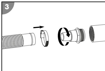
Der gesteckte Schwimmbadschlauch ist am Schlauch-Adapter montiert.
