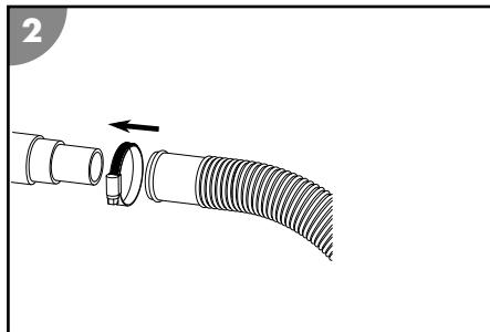
**Aby zamontować przewód basenowy metodą wtykową na adapterze węża pompy lub adapterze zbiornika filtra, postępuj zgodnie z poniższym opisem:**
