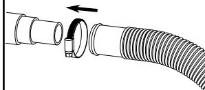
**Procedați după cum urmează pentru a introduce un furtun pentru bazin pe adaptorul pentru furtun al pompei sau al rezervorului de filtrare:**
